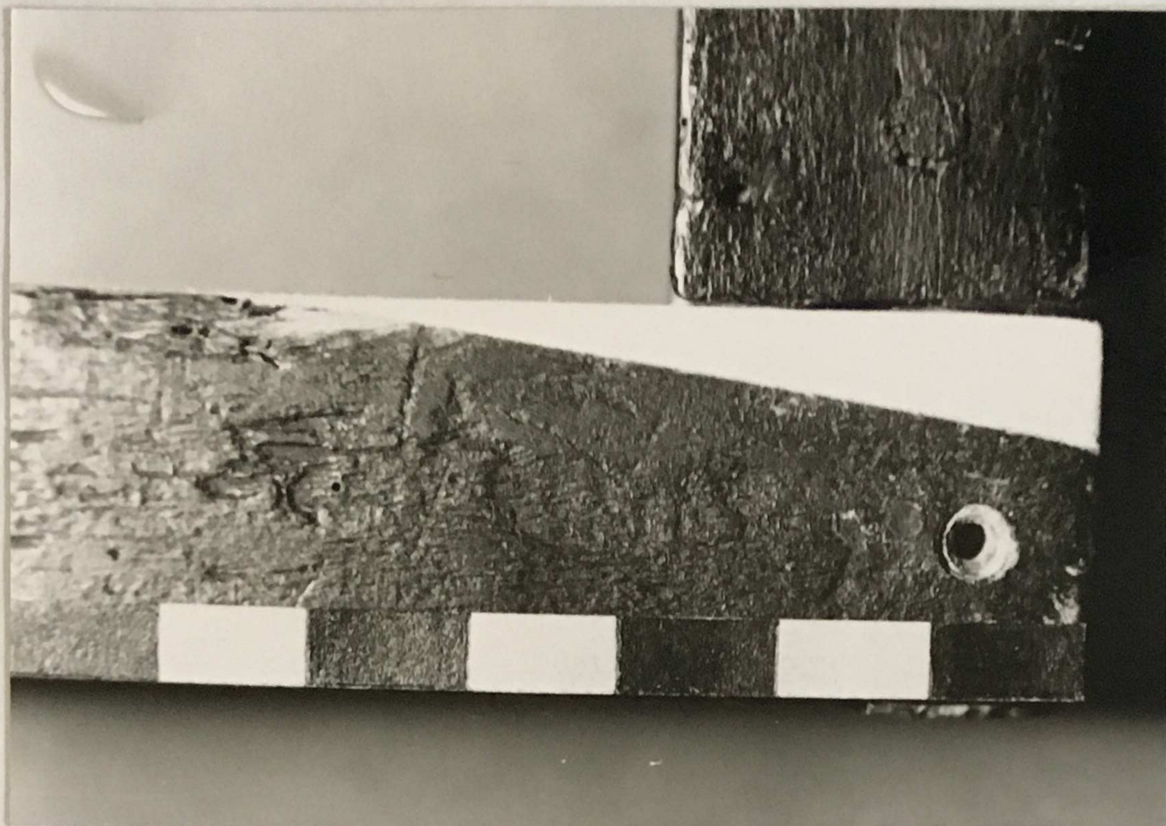
4 Ergänzung rüchseitig ausgebrochener Rahmennut in Linde
